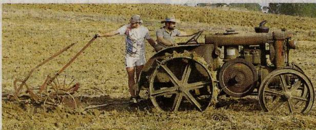
Encore vaillant, sans pneus et à roues en fer à crampons! Les décibels en plus, sans casque aux oreilles.
